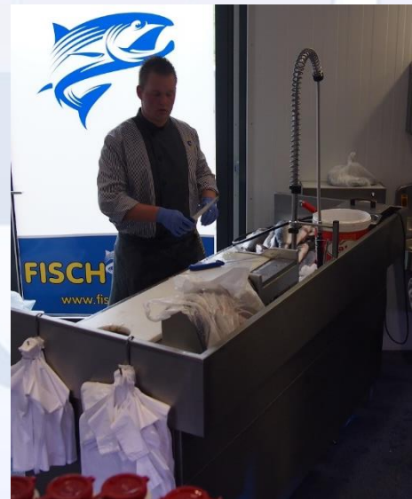
Maßgefertiger Filetiertisch mit Starkstromanschluss für eine Enthäutungsmaschine
